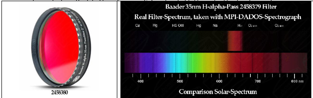
6.2 Φίλτρα Αστροφωτογράφησης **H<sub>α</sub>** (656.3nm) (Φίλτρο Γραμμής Εκπομπής Εύρους: 7nm)
