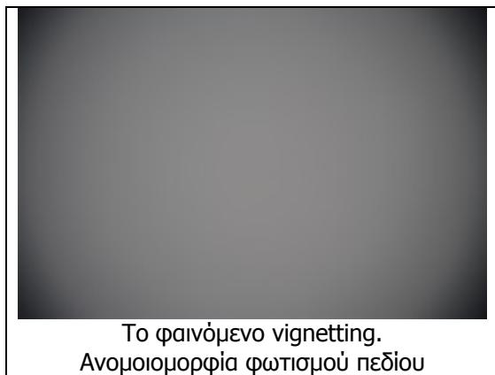
Επίσης θα πρέπει να έχουμε υπόψη, πως αν χρησιμοποιούμε μειωτή εστιακού λόγου (focal reducer), θα πρέπει να χρησιμοποιούμε ακόμη μεγαλύτερα φίλτρα και αντάπτορες διότι η γεωμετρία του κώνου φωτός αλλάζει δραστικά και το vignetting θα είναι εντονότερο.
